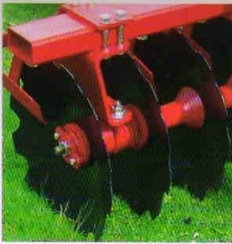
Equipada con limpiadores reforzados y chumacera engrasable con doble cojinete
