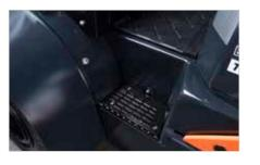
Barra de sujeción de entrada fácil y placa antirresbalamiento en el peldaño
