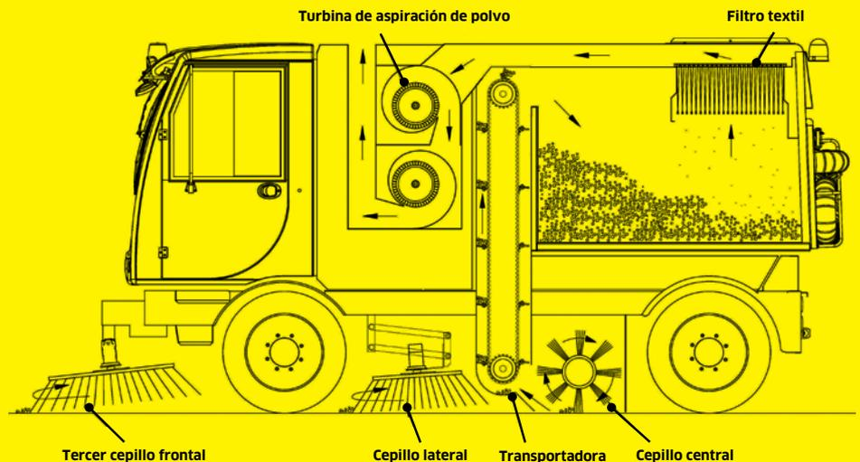
La colección combinada mecánica / de aspiración / filtrado garantiza la carga eficiente y rápida de cualquier tipo de material, desde de polvo a las hojas, así como a gravilla y residuos. El eficiente sistema de aspiración optimiza la recolección de polvo y materiales ligeros. El filtro de bolsillo de poliéster captura partículas finas de polvo hasta PM1 en todas las condiciones operativas. Por lo tanto, la introducción de contaminantes en la atmósfera también se elimina por completo.
