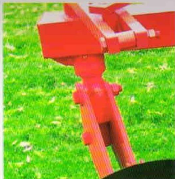
Tornillo de ajuste para penetración y nivelación de la rueda guía en terrenos difíciles
